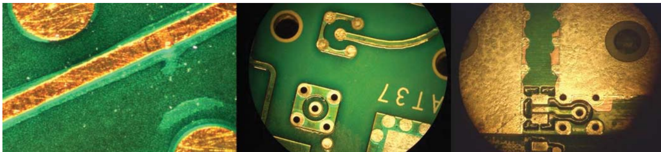
图5-7 清洗后干膜阻焊膜剥离和脱落
