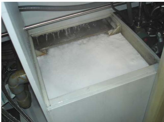
图8-10 排气调整前的冲洗阶段泡沫
