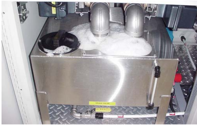
图8-14 洗涤阶段中的泡沫
