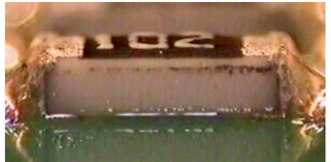
图8-1 夹裹在元器件下面的助焊剂残留物
