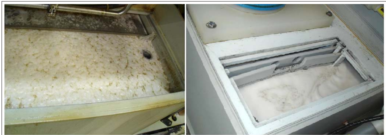
图8-8 泡沫开始溢出到两个不同的洗涤阶段
