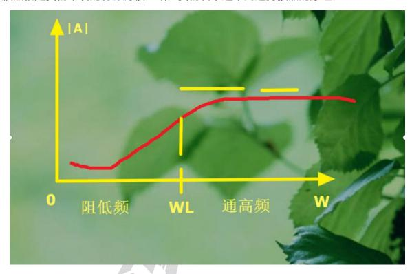
高通滤波器:允许高频信号通过,将低频信号衰减。我们可以看下图中所示,当信号 处于低频段的时候我们的幅频特性如下。
