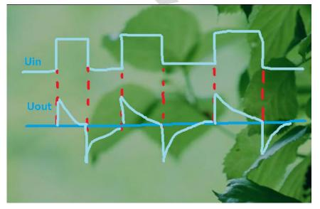
我给大家总结一下,微分电路 其实就是通过,电容的不能突 变的特性,让我们的脉冲不断 产生尖波,从而求出我们的输 入信号的突变成分,也就是通 过改变电容和电阻阻值,来获 得某一频率范围下的信号,通 过一系列的尖波突变,我们可 以知道 Uin 输入的大小不变, 结论:微分电路无输出
