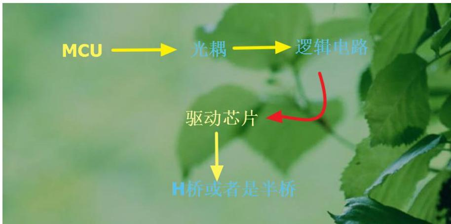
Mcu 输出控制信号，同时我使用光耦进行隔离，同时光耦连接我们的数字逻辑电路，通过逻辑来控制我们的驱动芯片，进一步使用我们的驱动芯片来驱动我们的 H 桥和半桥。
