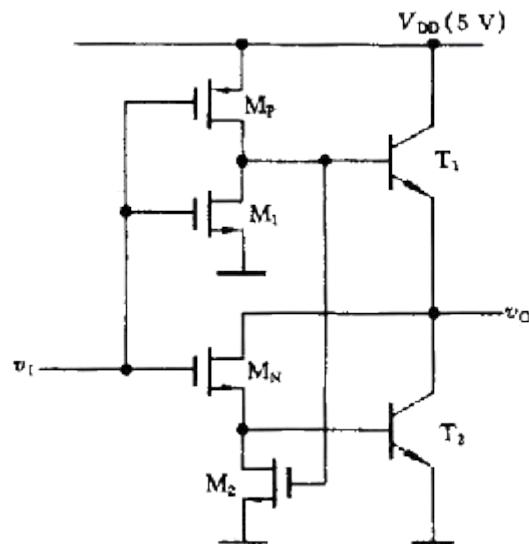
上图表示基本的 BiCMOS 反相器电路，为了清楚起见，MOSFET 用符号 M 表示 BJT 用 T 表示。T<sub>1</sub>和 T<sub>2</sub>构成推拉式输出级。而 M<sub>P</sub>、M<sub>N</sub>、M<sub>1</sub>、M<sub>2</sub>所组成的输入级与基本的 CMOS 反相器很相似。输入信号 v<sub>I</sub>同时作用于 M<sub>P</sub>和 M<sub>N</sub>的栅极。当 v<sub>I</sub>为高电压时 M<sub>N</sub>导通而 M<sub>P</sub>截止；而当 v<sub>I</sub>为低电压时，情况则相反，M<sub>P</sub>导通，M<sub>N</sub>截止。当输出端接有同类 BiCMOS 门电路时，输出级能提供足够大的电流为电容性负载充电。同理，已充电的电容负载也能迅速地通过 T<sub>2</sub>放电。
