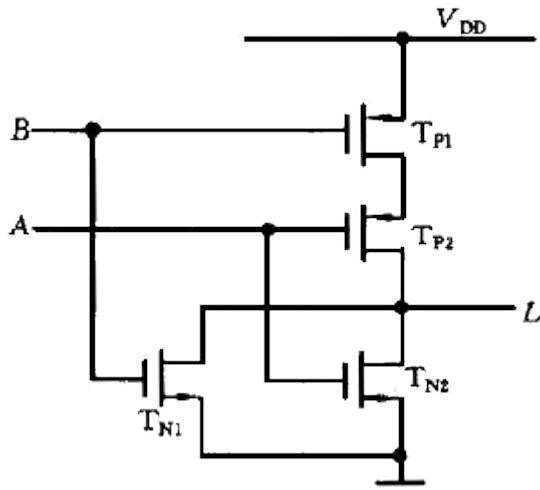
当输入端 A、B 中只要有一个为高电平时，就会使与它相连的 NMOS 管导通，与它相连的 PMOS 管截止，输出为低电平；仅当 A、B 全为低电平时，两个并联 NMOS 管都截止，两个串联的 PMOS 管都导通，输出为高电平。
