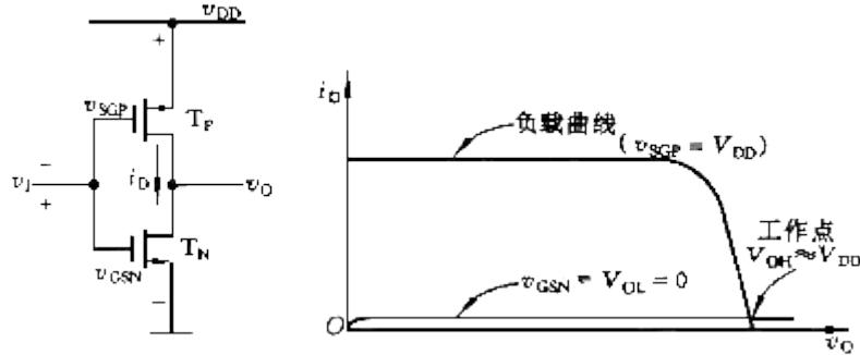
由此可知，基本 CMOS 反相器近似于一理想的逻辑单元，其输出电压接近于零或 $+V_{DD}$ ，而功耗几乎为零。
