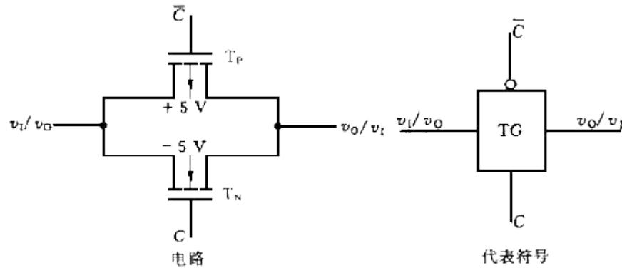
所谓传输门 (TG) 就是一种传输模拟信号的模拟开关。CMOS 传输门由一个 P 沟道和一个 N 沟道增强型 MOSFET 并联而成，如上图所示。T<sub>P</sub> 和 T<sub>N</sub> 是结构对称的器件，它们的漏极和源极是可互换的。设它们的开启电压  $|V_T|=2V$  且输入模拟信号的变化范围为 -5V 到 +5V。为使衬底与漏源极之间的 PN 结任何时刻都不致正偏，故 T<sub>P</sub> 的衬底接 +5V 电压，而 T<sub>N</sub> 的衬底接 -5V 电压。两管的栅极由互补的信号电压 (+5V 和 -5V) 来控制，分别用 C 和  $\bar{C}$  表示。
