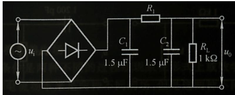
图 6.2.1-6  $\pi$  型  $RC$  滤波电路
