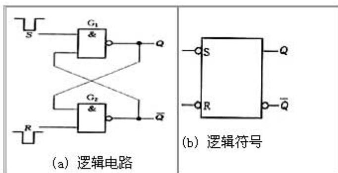
图 7.2.1 两与非门组成的基本 RS 触发器
