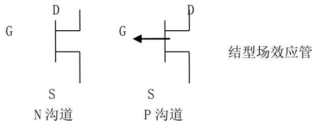
6.4 场效应管的三个引脚分别表示为: G(栅极), D(漏极), S(源极)
