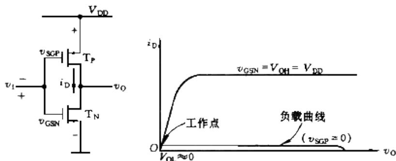
下图分析了另一种极限情况，此时对应于  $v_I=0V$ 。此时工作管  $T_N$  在  $V_{GSN}=0$  的情况下运用，其输出特性  $i_D-v_{DS}$  几乎与横轴重合，负载曲线是负载管  $T_P$  在  $V_{SGP}=V_{DD}$  时的输出特性  $i_D-v_{DS}$ 。由图可知，工作点决定了  $V_O=V_{OH}\approx V_{DD}$ ；通过两器件的电流接近零值。可见上述两种极限情况下的功耗都很低。
