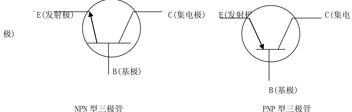
5.4 半导体三极管放大的条件: 要实现放大作用, 必须给三极管加合适的电压, 即管子发射结必须具备正向偏压, 而集电极必须反向偏压, 这也是三极管的放大必须具备的外部条件。
