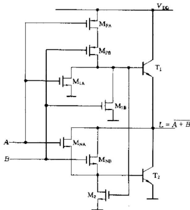
当 A 和 B 均为低电平时，则两个 MOSFET M<sub>PA</sub> 和 M<sub>PB</sub> 均导通，T<sub>1</sub>导通而 M<sub>NA</sub> 和 M<sub>NB</sub> 均截止，输出 L 为高电平。与此同时，M<sub>1</sub>通过 M<sub>PA</sub> 和 M<sub>PB</sub> 被 V<sub>DD</sub> 所激励，从而为 T<sub>2</sub>的基区存储电荷提供一条释放通路。
