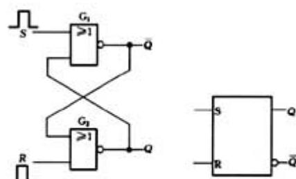
图 7.2.2 两或非门组成的基本 RS 触发器
