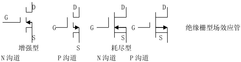
注: 场效应管属于电压控制型元件, 又利用多子导电故称单极型元件, 且具有输入电阻高, 噪声小, 功耗低, 无二次击穿现象等优点。
