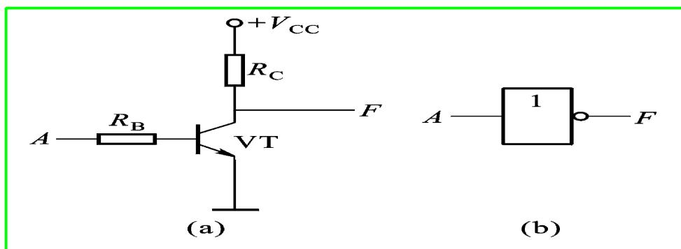
即输出端总是与输入端相反. 非门的常用芯片型号有:74LS04, 74LS05, 74LS06, 74LS14 等.
