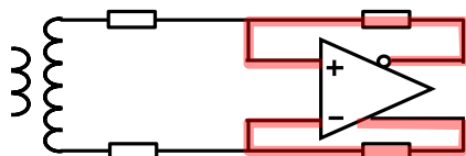
图 4-9 全差分放大器可接受浮空输入
