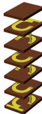
片状电感器的层叠构造
