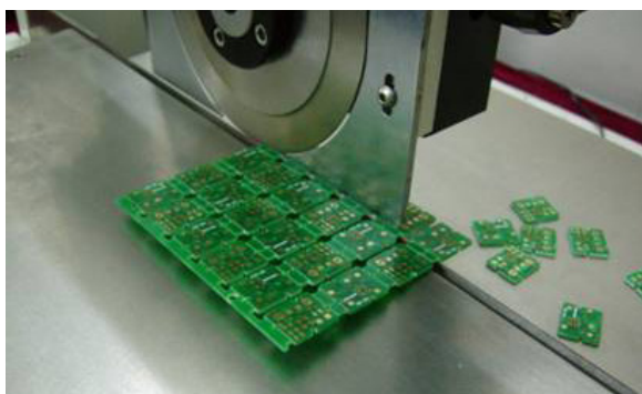
图7.4：使用V-切割机切割PCB基板
