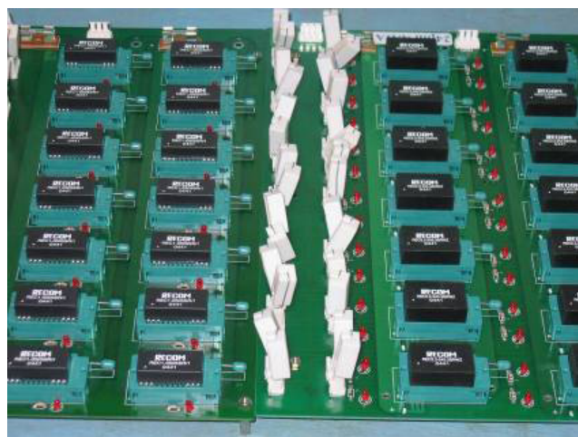
图7.2: DC-DC转换器在预烧室中进行测试 ( T_{AMB}=40^{\circ}C )
