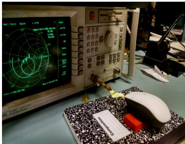
Figure 47. 使用塑料装置时的 Smith Chart, 连接至 ID 的图表
