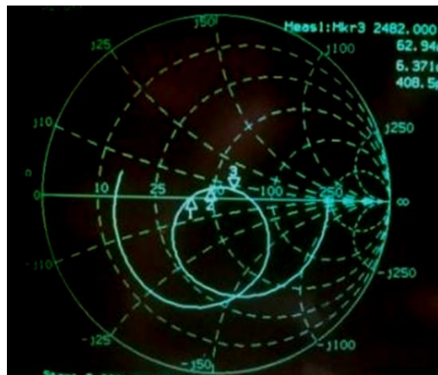
Figure 45. 使用实际组件的 Smith 图表
