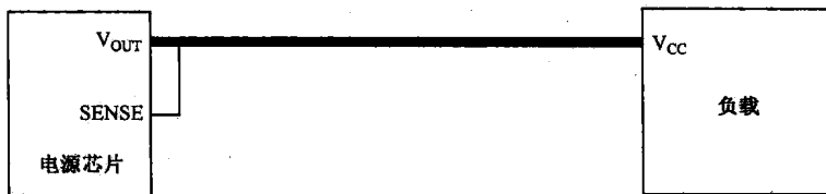
图 4.11 不使用 SENSE 功能时 SENSE 引脚的处理
