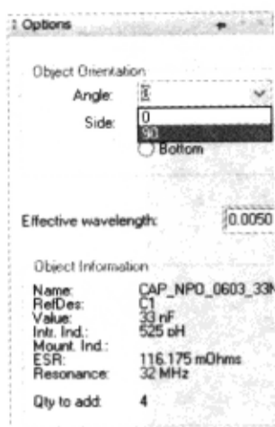
图 9-7-28 去耦电容器相关信息
