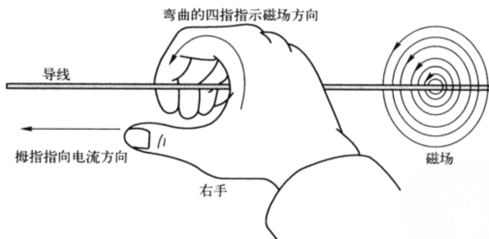
图 1-3-6 电流流过导体会产生磁场
