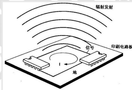
图 1 PCB 的电磁辐射
