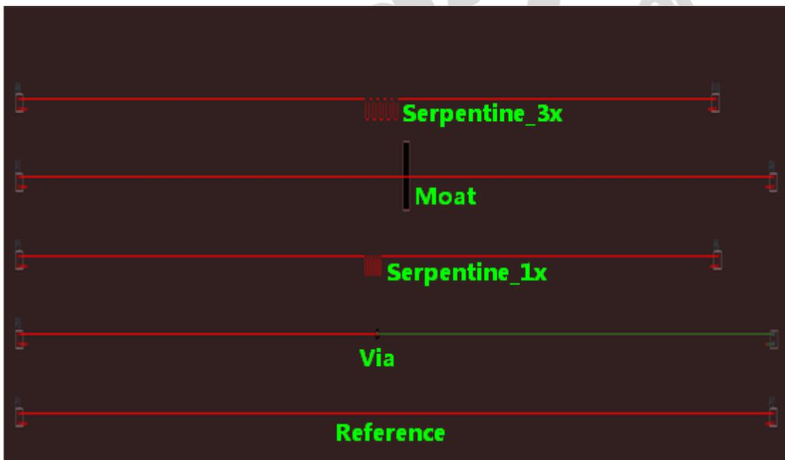
Case1: 过孔带来的时延差值为 11ps，这个就很好理解了，过孔有一定的物理长度，该过孔长 1mm，过孔本身还具有寄生电容和寄生电感，所以实际带给信号的传输线延会比普通传输线要大，本例中是 11ps，而且这个延时跟频率有一定关系。使用软件单独提取该过孔的模型，如下图，过孔的延时为 10ps，与仿真得到的 11ps 差不多。
