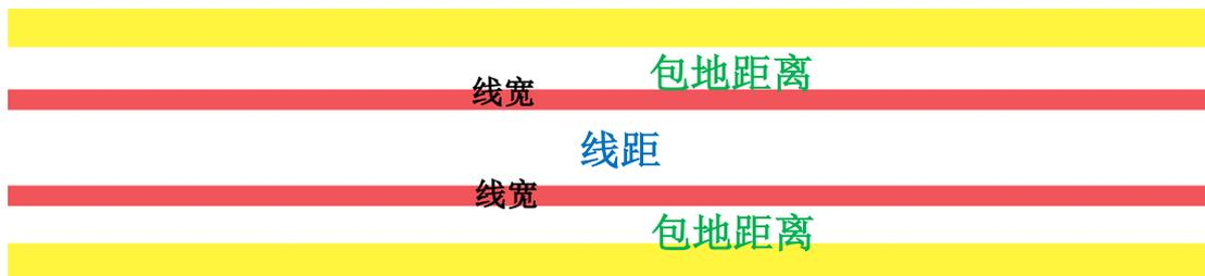
板子很简单，这些 10Gbps 的高速线就几对，因此工程师在我们高速先生还没反应过来就已经把走线走出来了，几 inch 的走线，走线走在表层，底层铺下地，然后中间打一些地过孔，距离大概 500mil 左右的地孔，部分 PCB 走线如下所示：
