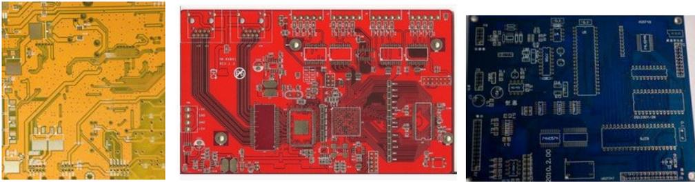
PCB 行业内,有人说黑色油墨炫,黑色油墨酷,不管这种瞎忽悠的说法正确与否,但是通常 PCB 工厂做黑色油墨都想哭。因为黑色油墨在曝光工序对紫外光的能量吸收特别强。(相信在夏天穿过黑色衣服的人,对此点感触比较深。)通常黑色油墨的阻焊桥需要做到 4mil,甚至目前有些工厂因设备和工艺能力的限制,现在的黑油桥还在 5-6mil 的制程能力上徘徊。所以有黑油桥的焊盘间距为焊盘两边开窗 2mil+4mil (阻焊桥宽度)+2mil=8mil。
