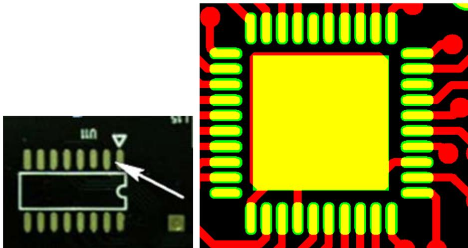
嘿嘿，阻焊桥是不是听着高大上，看到很失望。阻焊桥的作用就是防止焊接时焊料流动，防止器件连锡短路等。
