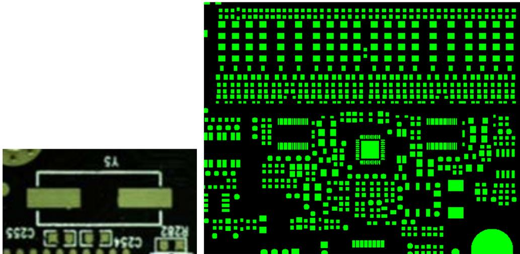
盖线，盖线指阻焊油墨盖住线路部分的大小及多少。阻焊开窗过大，盖线距离过小在生产过程中就会造成露线亮铜。
