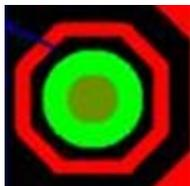
光学定位点直径 40mil，开窗直径 80mil，光学定位点保护环大小 110mil 的八边形或圆形，线条 12mil 宽。
