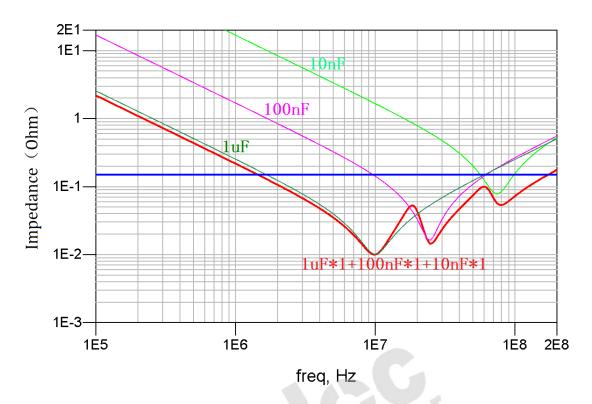
以图中的蓝色直线为目标阻抗线,对比可以看出,数量相同的情况下,相同容值 电容并联的阻抗没有多容值组合的效果好,因为"V"字造型虽然在某些特定的 场合有着强大的诱惑力,但是对于 PDN 阻抗并不是最佳选择,因为大起大落来 的太突然,阻抗只能在较窄的频段内控制在目标阻抗之下,而且费力不讨好,为 满足相同的目标阻抗要求, 所需电容数量多, 成本高。相比之下, 波澜不惊的多 容值组合更显淡定从容,不同容值的电容各司其职,分区而治,可以在较宽的频 段内都将 PDN 阻抗压制在目标阻抗线以下,减少使用的电容数量,降低成本。
