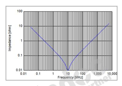
了解了电容的阻抗特性,下面我们就来看看对于滤波电容如何物尽其用,用尽量少的电容在尽量宽的频段内保持 PDN 阻抗低于目标阻抗(即满足负载最大瞬态电流供应,且在电压变化不超过最大允许波动范围的情况下,电源系统自身阻抗的最大值)。不妨来比较下相同容值的电容组合与不同容值组合的滤波效果:
