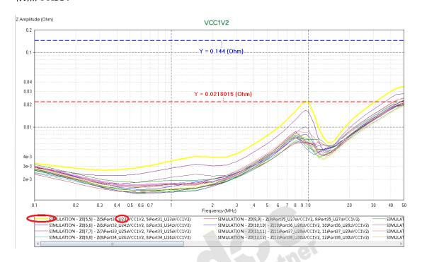
于是我们果断建议每个颗粒拿掉 5 个 0.1uF 电容, 20 个颗粒就可以减少 100 个电容!幸福来得太突然,客户有点懵圈,在我们的再三确认和怂恿,不,是鼓励下,用户接受了建议。在板子的试产阶段,细心的客户还对电容精简前后的电源噪声进行了测试对比,结果如下:
