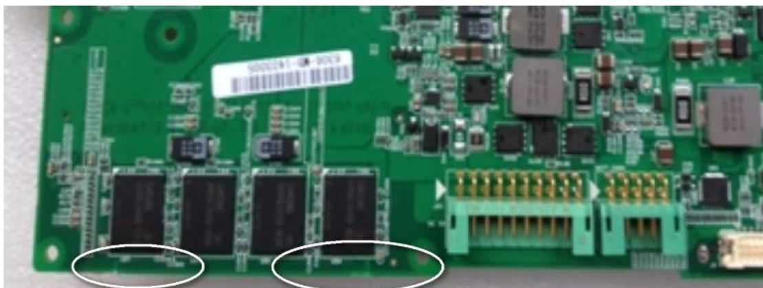
在 PCB 的板边处有多处芯片，芯片下方设计有邮票孔，其中两处邮票孔分板后，因应力问题导致 PCB 出现分层，此板是 10 层板，第四层信号层靠近板边的地方，有走线分布。分层了，走线裸露了，板子 GAME OVER 了。。。。
