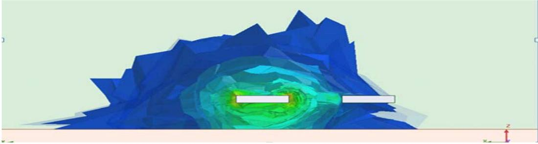
传输线中有电流通过时，电磁场能量分布类似正态分布，约 70% 地能量集中在导线周围  $3H$  范围内。如果两导线距离大于  $3H$ ，两导线之间的互感会急剧下降，能效降低的串扰量。这就是 PCB 设计工程师  $3H/W$  经验法则的由来。根据经验法则两线间距  $3W$  情况下，近端串扰约在 1.9%，远端串扰约 -2.2%（仅微带线，带状线几乎没有远端串扰，这也是我们建议高速传输线在内层布线的原因）。 $H$  是指走线到参考层的高度，因为常用 50 欧姆阻抗线线宽  $W$  接近  $H$ ，为了量化通常用  $W$  表述，实际设计中  $W$  通常都大于  $H$ 。另外减小  $H$  能加强与 GND 平面的耦合，使能量集中在更小的范围，相同间距下串扰更小。由于  $H$  减小，阻抗线线宽也会减小，不需要额外空间就增加了间距，再次减少串扰。有这个技能你 get 到了吗？（下记是  $3W$  经验法则的示意图）
