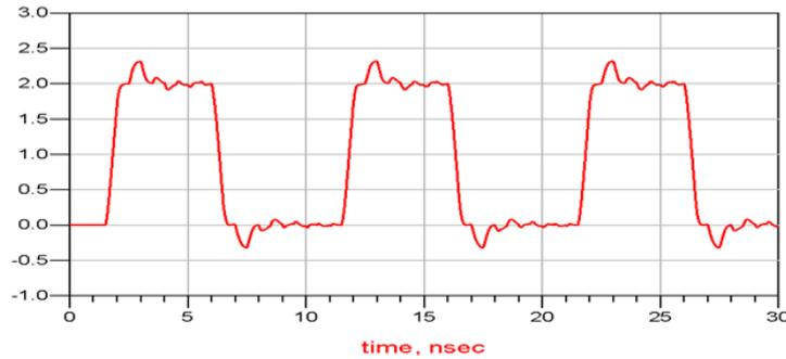
通过信号仿真波形可以看到，由于传输线中途有  $8\text{nH}$  的感性突变，反射使信号产生过冲，过冲幅度约是  $300\text{mV}$ 。
