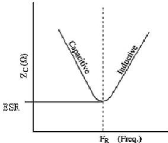
从上图，我们很清楚的看出：电容在整个频段，并非都是表现为电容的特性，而是在低频的情况(谐振频率以下)，表现为电容性的器件，而当频率增加(超过谐振频率)的时候，它渐渐的表现为电感性的器件。也就是说它的阻抗随着频率的增加先减小后增大，等效阻抗的最小值发生在串联谐振频率时，这时候，电容的容抗和感抗正好抵消，表现为阻抗大小恰好等于寄生串联电阻 ESR。
